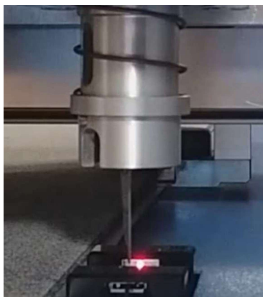
Capteurs d'étalonnage d'outils en option. Mesure automatique de la longueur de la lame de coupe pour une profondeur de coupe précise.
