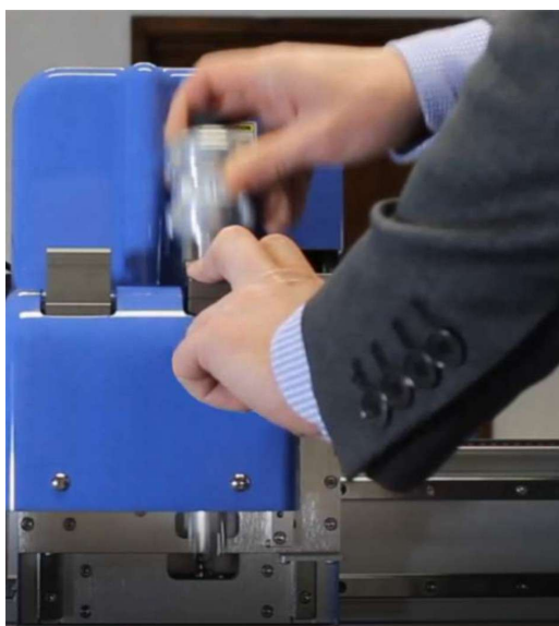
Changement rapide d'outil. Permet de passer rapidement et facilement d'un type de matériau à un autre.
